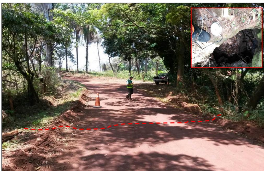
Figura 2 - Superfície sobre a caverna MJ-0001: a linha tracejada indicando a projeção linear aproximada da cavidade sob a estrada. No detalhe acima à direita, geofone do sismógrafo instalado no maciço que compõe o teto da cavidade.
